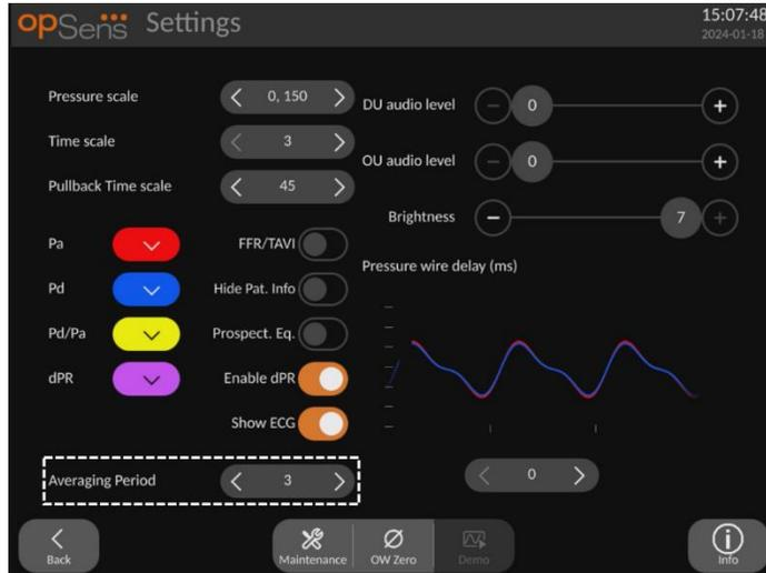
Se si utilizza l'ingresso del trasduttore per il segnale aortico, è disponibile l'opzione per l'impiego dell'ingresso ausiliare per visualizzare un segnale ECG. Il segnale ECG può essere visualizzato o nascosto utilizzando l'impostazione Mostra ECG.
