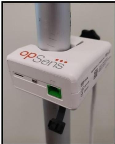
L'Unità Manipolo OptoMonitor 3 consente il collegamento tra il filo guida per pressione OpSens e l'Unità Ottica. Anche l'Unità Manipolo è provvista di un LED sul lato anteriore, che fornisce diverse segnalazioni all'utilizzatore (vedere la sezione 3.6.2).
