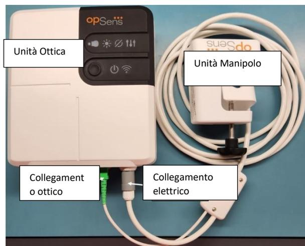
1. L'Unità Manipolo si collega all'Unità Ottica. Verificare che il connettore elettrico (bianco) e il connettore ottico quadrato (verde) siano collegati in modo sicuro.
