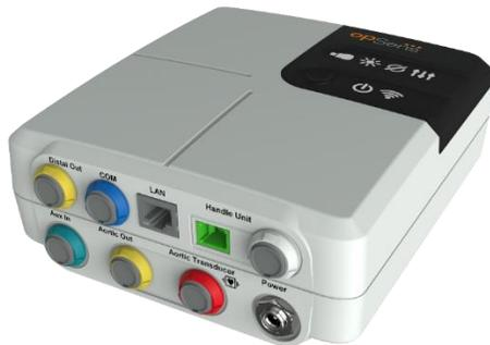
L'Unità Ottica calcola la pressione rilevata dai fili guida per pressione OpSens: OptoWire™ e SavvyWire™. L'unità principale fornisce i collegamenti al sistema emodinamico del laboratorio di cateterismo, al trasduttore aortico, all'Unità Display e all'Unità Manipolo. L'Unità Ottica è provvista di 6 LED sul lato anteriore, che forniscono diverse segnalazioni all'utilizzatore (vedere la sezione 3.6.2).
