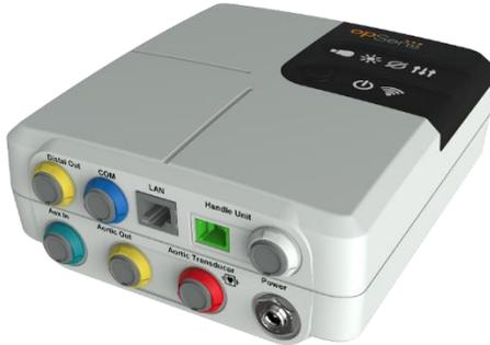
L'unité optique calcule la pression mesurée par le fil-guide de mesure de pression OpSens. OptoWire™ et SavvyWire™. C'est l'unité principale qui fournit les connexions avec le système hémodynamique du laboratoire de cathétérisme, le capteur de pression aortique, l'unité d'affichage et l'unité de poignée. La façade de l'unité optique comporte 6 voyants lumineux qui alertent l'utilisateur de différentes manières (voir la section 3.6.2).
