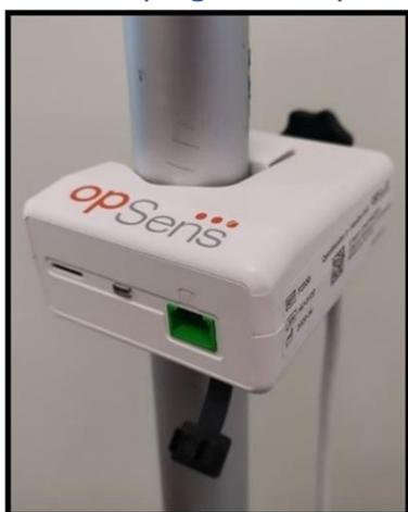
L'unité de poignée du système OptoMonitor 3 assure la liaison entre le fil-guide de mesure de pression OpSens et l'unité optique. La façade de l'unité de poignée comporte un voyant lumineux qui alerte l'utilisateur de différentes manières (cf. section 3.6.2).
